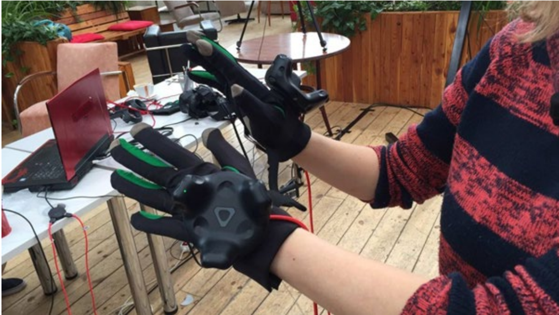
Obrázek 2 – Haptické rukavice (Zdroj: Český Rozhlas, 2018)
